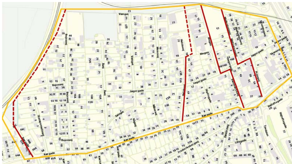
Figur 6.2.1: Placering af skybrudsveje. Rød streg er hovedskybrudsveje hvor vejprofil ændres. Rød stiplede streg er hvor der etableres anlægsgrøft til håndtering af skybrudsvand. Den orange afgrænsning indikerer hvor der kigges lokalt på lokale skybrudsveje til håndtering af lokalt regnvand.
