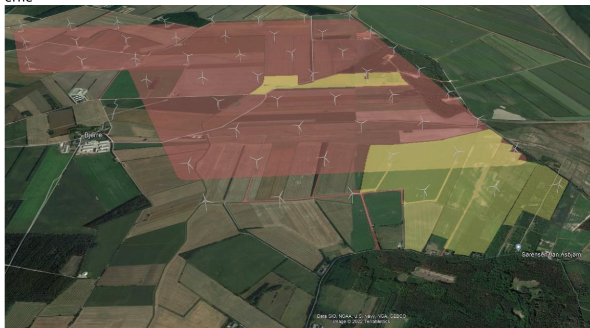
Figur 2: Illustration af arealet til solcelleanlægget med gult, godkendt lokalplan og godkendte vejadgang til de 46 vindmøller, markeret med rødt samt udvidelsen med 6 nye vindmøller syd for.
